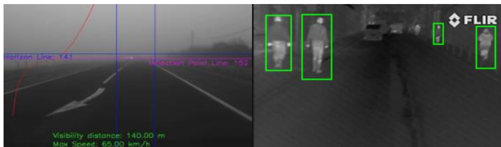
Rezultate obținute pentru (de la stânga la dreapta): detecția ceții și detecția pietonilor cu termoviziune.
